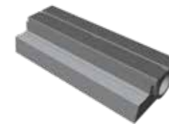
BODAN S-BORD - Auflagerstein mit integrierter Schlitzrinne - verhindert Verschmutzung des Gleisschotters und die Durchfeuchtung des Gleisbettes - frost- und tausalzbeständig - hohe Rutschfestigkeit durch kornraue Oberfläche - aus Polymerbeton
