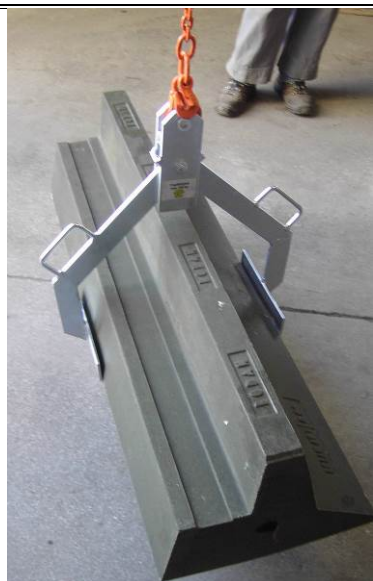
Bild 5; Demonstration des Werkzeuges - Kugelkopf-Hebekopf 1,5 – 2,5 to
