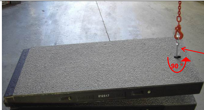
Bild 11; Demonstration des Zusatzwerkzeuges zum Anheben der BODAN-Außenplatten - Hebeschlüssel und 4-Strang Kettengehänge
